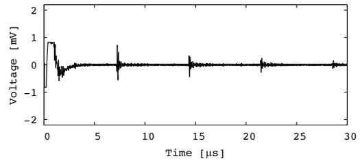
Fig. 8 Echo signal ( $\phi=4.3$  mm).
