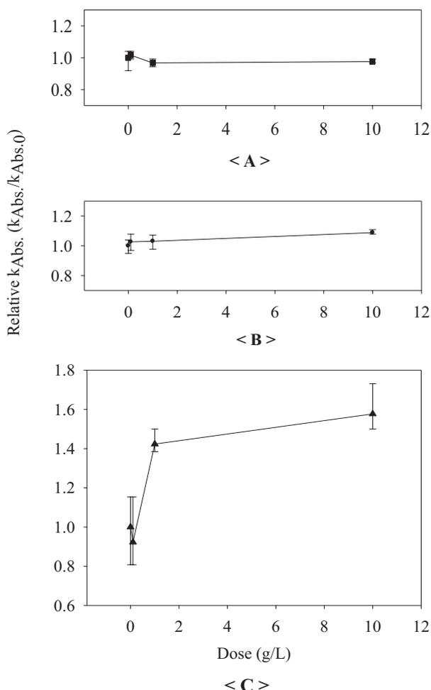
**Fig. 2** Relative kinetic constants depending on doses of particles at <A> 35 kHz, <B> 283 kHz, <C> 930 kHz. (Power 90W, Particle size 35  $\mu\text{m}$ , Doses 0.1, 1, 10 g/L)
